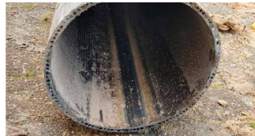
Figuur 3.1 PVC-buis met een met langskanalen geconstrueerde wand
