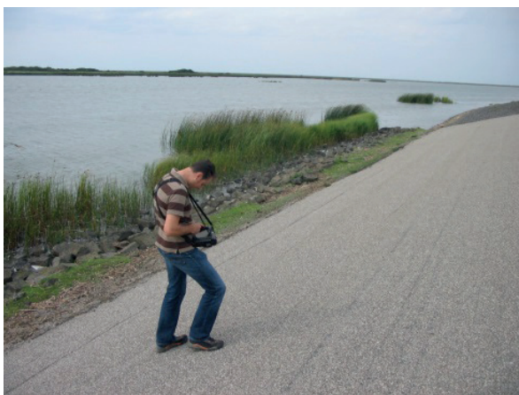
FIGUUR 4 VISUELE INSPECTIE MET BEHULP VAN EEN TABLET
