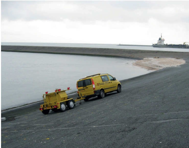
FIGUUR 8 VALGEWICHT-DEFLECTIEMETING OP EEN WATERKERING
