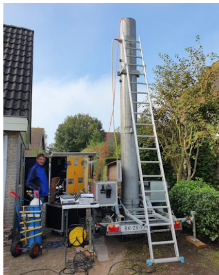
FIGUUR 3.2 WEERGAVE VAN DE OPSTELLING VOOR DE KOLOMPROEVEN MET DE DRINKWATERTESTEN
