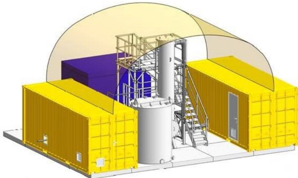
AFBEELDING 2.2 3D-WEERGAVE VAN DE O3-STEP FILTER PILOTINSTALLATIE
